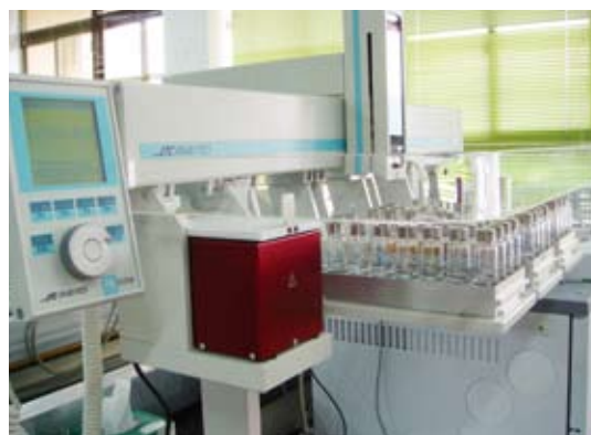
圖 3. 利用頂空萃取一氣相層析儀法檢測農產品中二硫代胺基甲酸鹽類藥劑。
