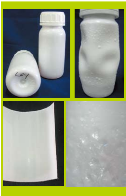
圖 19. 溶劑於塑膠容器內之熱貯處理。農藥包裝容器受浸蝕後變形 (上右)，經裁切展開可觀察其內部表面 (下左) 受浸蝕之現象 (下右)。
